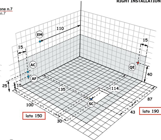
Allaccio acqua calda nel caso di vasca provvista di rubinetteria (AC) Hot water connection should the bathtub be fitted with taps
